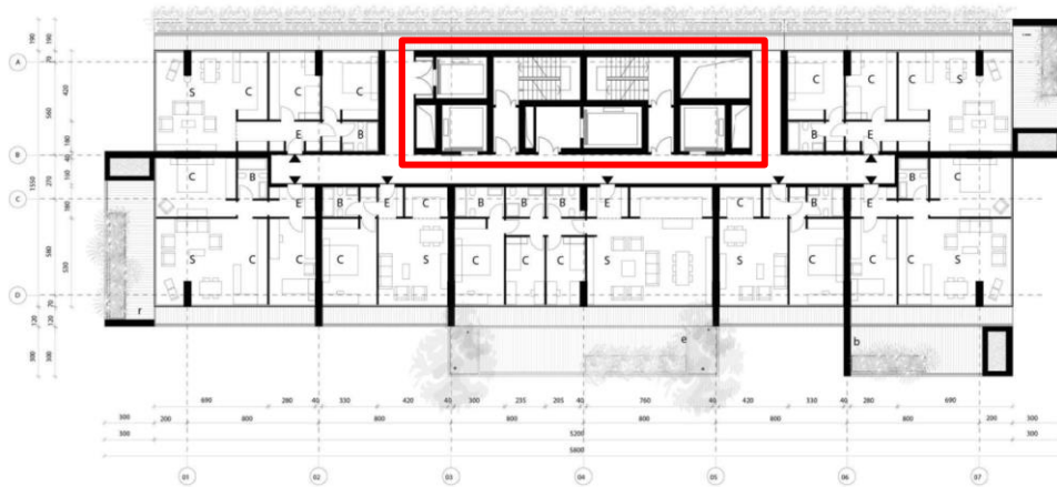
Figure 4 – Murs parasismiques pris en compte
